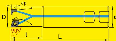
**ФРЕЗЫ КОНЦЕВЫЕ С ХВОСТОВИКОМ WELDON** (угол в плане 90°) с мелкогабаритными 2-гранными двусторонними пластинами (4 режущих кромки). Крепление винтом
