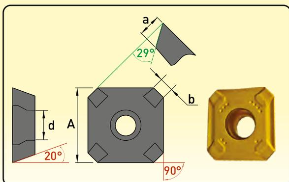
ПЛАСТИНЫ ДЛЯ ФРЕЗ: ТИП SM451320
