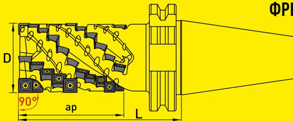
**ФРЕЗЫ ТОРЦОВО-ЦИЛИНДРИЧЕСКИЕ НАСАДНЫЕ (угол в плане 90°). ХВОСТОВИК SK50 DIN 69871**
