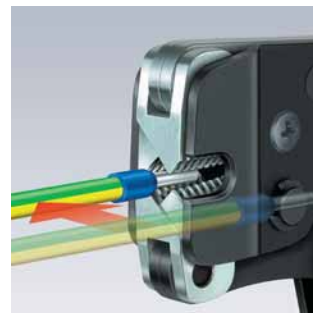
97 53 08: параллельное введение контактных гильз сбоку до 2,5 мм 2
