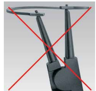
Обычные щипцы для стопорных колец: возможна деформация колец при монтаже
