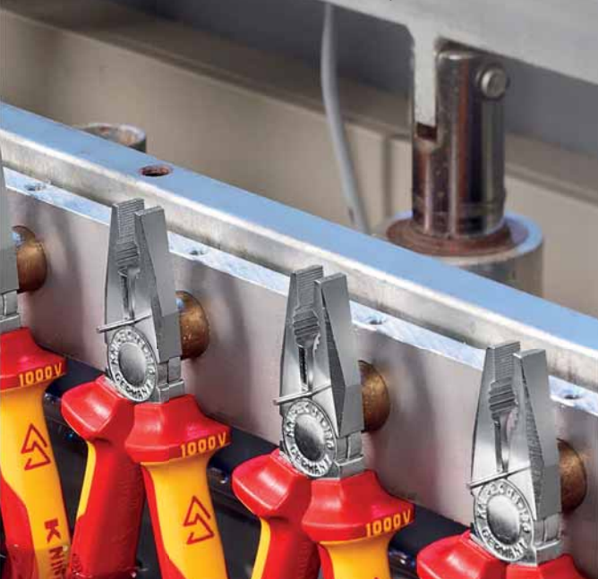
Тестирование каждого инструмента под напряжением 10.000 V AC.
