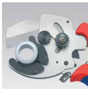
Чистое резание толстостенных пластмассовых и многослойных труб
